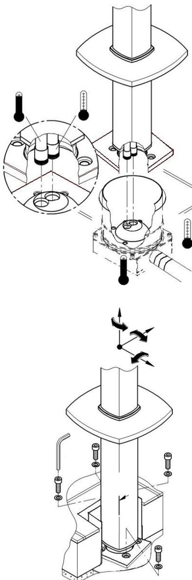
Marque en el piso los lugares para los orificios de fijación de la base según el lugar determinado y las dimensiones de montaje de la base. Retire la grifería coloque el protector donde se inserta la grifería. Taladre los orificios en el piso e instale la base dejándola firme y nivelada.
