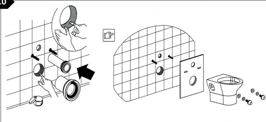
Lubrique las boquillas para instalar el tubo de descarga y la campana del desagüe. Pegue la espuma que va en medio de la pared y porcelana.
