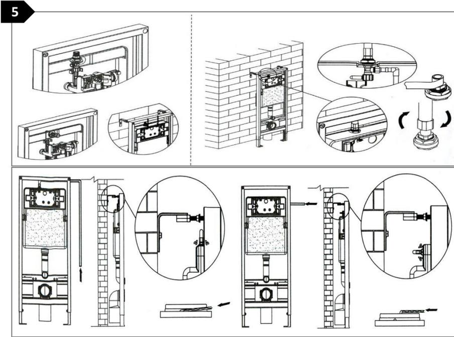
Realice la conexión hidráulica y compruebe que no haya quedado fuga de agua.
