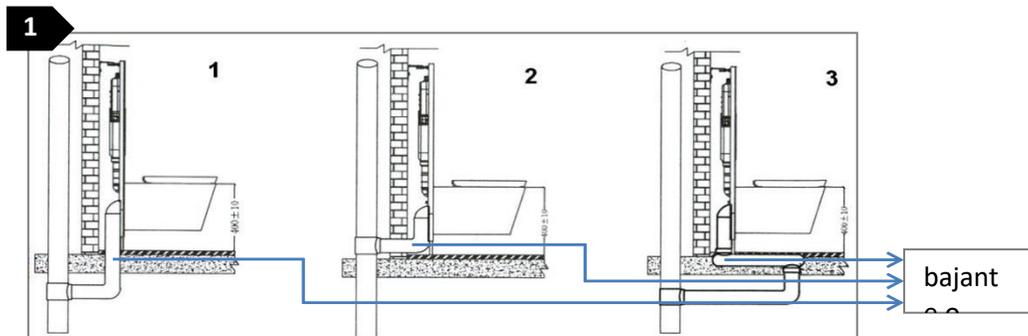
Ubique la bajante o desagüe para realizar la conexión sanitaria correspondiente.
