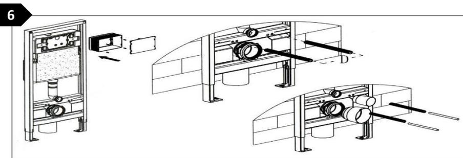
Instale el protector que va en lugar del pulsador para evitar que caigan escombros dentro del tanque, coloque los protectores a los tornillos para evitar que la rosca se deteriore o desgaste, coloque el tapón del desagüe para evitar malos olores y por último coloque el tapón para la tubería de descarga.
