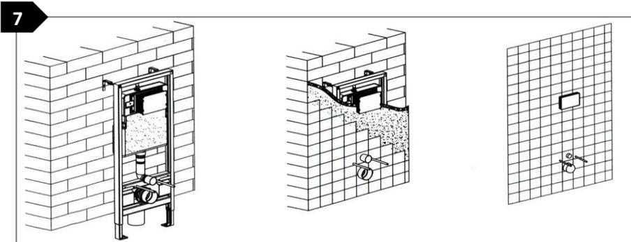
Cubrir la instalación del soporte duplo con obra teniendo en cuenta espacio para la placa de accionamiento, tornillos para sujetar la porcelana, el tubo de descarga y el codo de la bajante.
