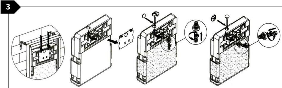
Retire la tapa de protección, ubique la entrada del punto hidráulico e instale la llave de suministro de agua al tanque.
