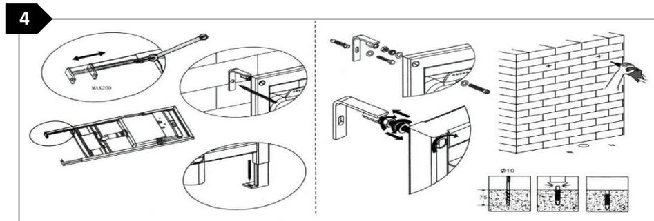
Nivele, ajuste y asegure a la pared y al piso, marque la altura que va a quedar de la cisterna.
