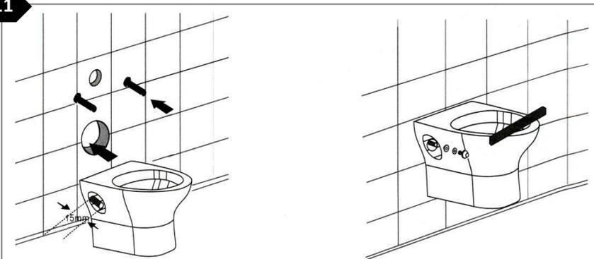
Deje los tornillos 15 mm afuera de la porcelana, nivele y ajuste el sanitario.
