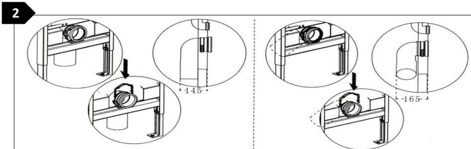
Instale y asegure el codo de descarga que puede ser en vertical o con una inclinación.
