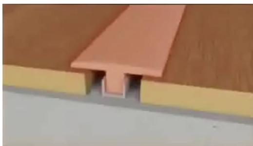
Para los casos en donde se presenten transiciones: cambio en el sentido de instalación del piso, cambio de material (porcelanatto, cerámica, alfombras, etc.), bocapuestas, entre otros; es imprescindible para cubrir estas dilataciones instalar perfiles de transición (perfil T) y compensación (perfil reductor).
